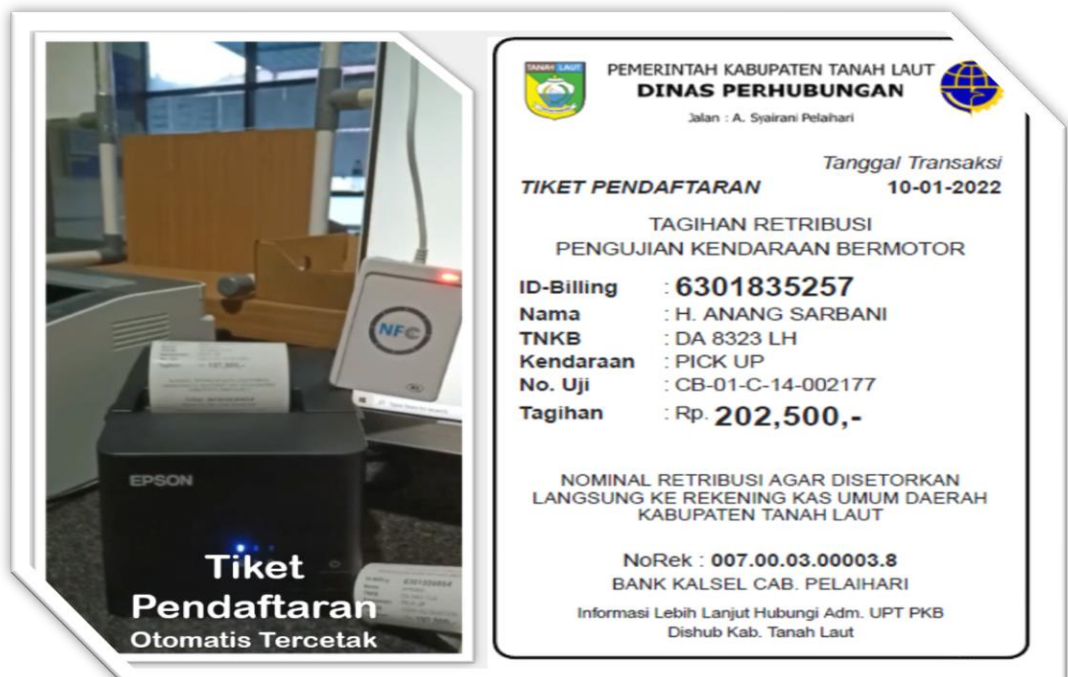
Gambar 3.1 : Printer Thermal yang Otomatis mencetak Tiket Pendaftaran
